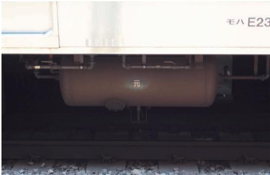
床下に吊り下げられている元空気溜め（写真はE231系のもの）。空気圧縮機で作られた圧縮空気を溜めておくタンクだ。空気を利用すると、圧力を伝えるものを補充する必要がないのも利点だ。
