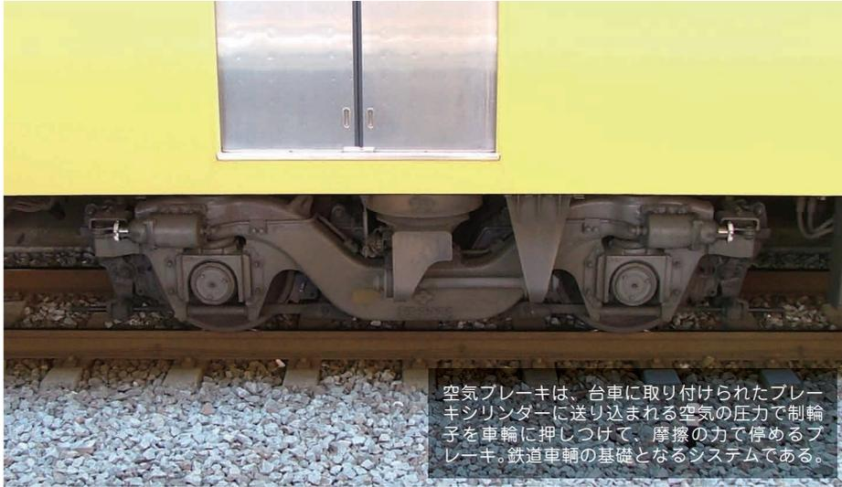
空気ブレーキは、台車に取り付けられたブレーキシリンダに送り込まれる空気の圧力で制輪子を車輪に押しつけて、摩擦の力で停めるブレーキ。鉄道車輛の基礎となるシステムである。
